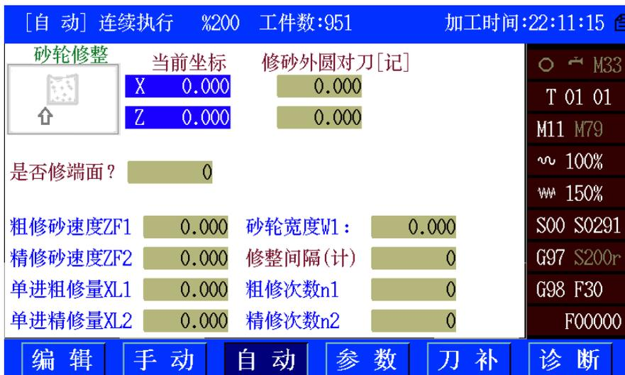
**修砂外圆对刀[记]:** 手动页面下，输入【M50】或【0】键后，按【3】，记录修砂轮外圆对修整笔的位置。
