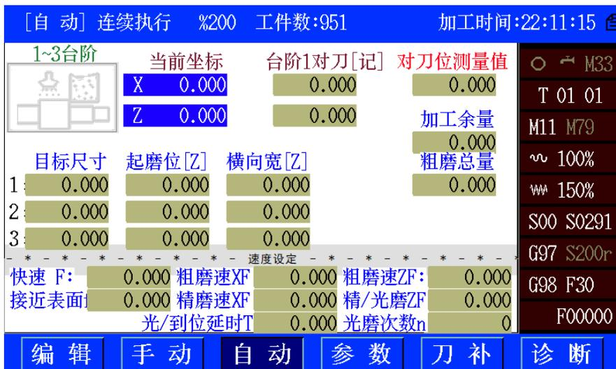
**台阶 1 对刀[记]:** 手动页面下，输入【M50】或【0】键后，按【1】，记录砂轮试磨工件的零点位置。
