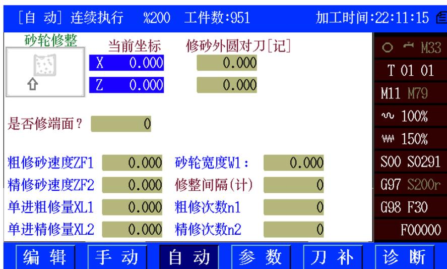
**端面量仪对刀[记]:** 手动页面下，输入【M50】或【0】键后，按【2】，记录端面量仪碰到工件端面的零位。
